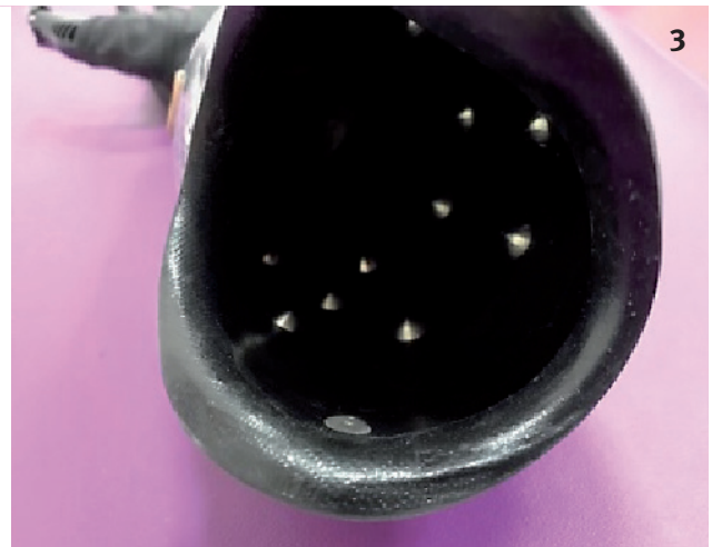
Onderarmprothese met 18 elektrodes voor aansturing via patroonherkenning.
