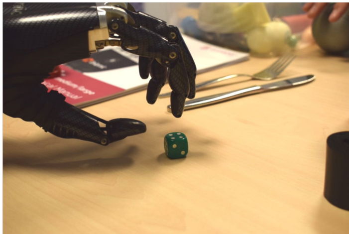
Figuur 2. Op de prothese kunnen meerdere grepen geprogrammeerd worden die basale handelingen mogelijk ma-
